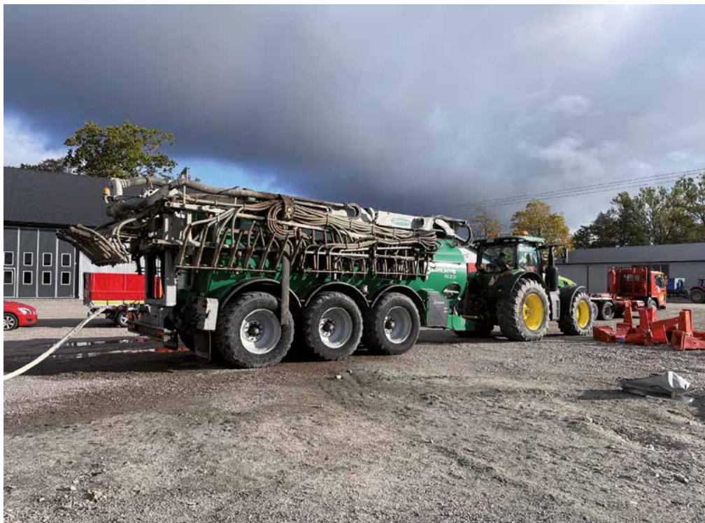
När Hasse Wetterstens övergångskoppling testades vid NUC i Göteborg, användes en traktor och en gödseltank på 25 m 3 som släckenhets, utrustad med centrifugalpump och digital mätning för tryck och flöde.
