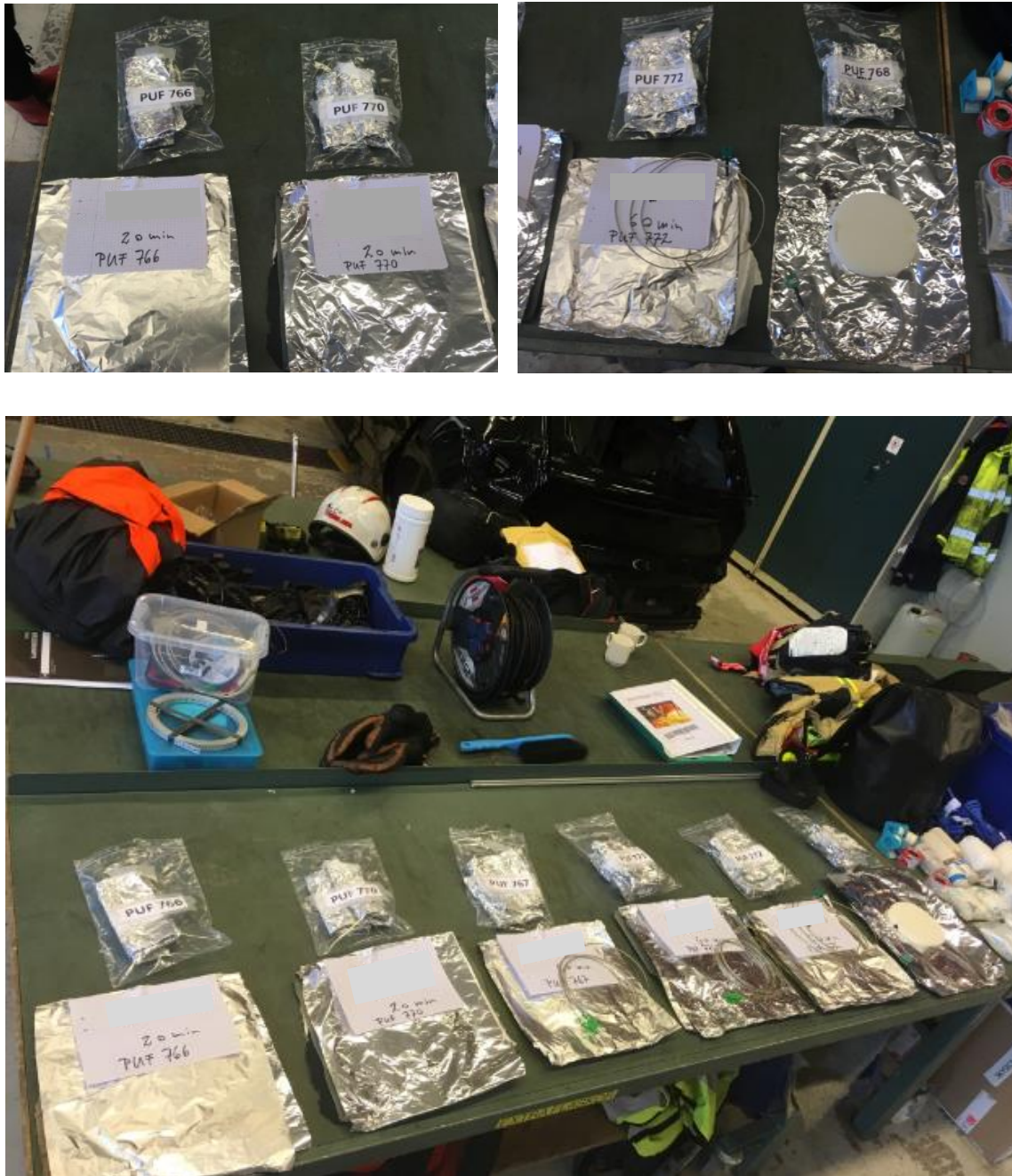
Figur B1.1 Paket med PUF-provtagare och textilier förberedda inför provning i testrigg.
