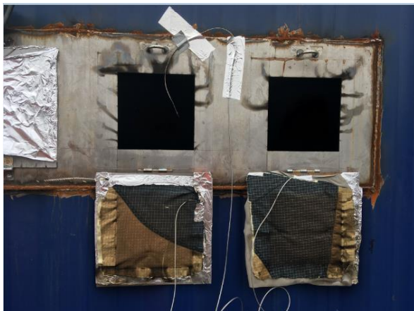
Figur B1.3 Testrigger sedd utifrån. Det översta fotot till vänster visar luckorna innan materialproverna applicerats. Överst till höger har materialproverna applicerats inför försöket. De två undre fotona visar materialproverna efter exponering för brandrök.
