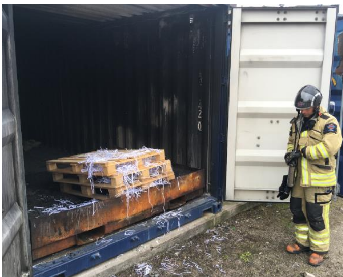
Figur B1.2 Testrigg i form av stålcontainer förberedd inför provning av textilier. De översta fotona visar fem luckor där materialproverna applicerades.
