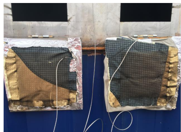
Figur B1.3 Testrigger sedd utifrån. Det översta fotot till vänster visar luckorna innan materialproverna applicerats. Överst till höger har materialproverna applicerats inför försöket. De två undre fotona visar materialproverna efter exponering för brandrök.
