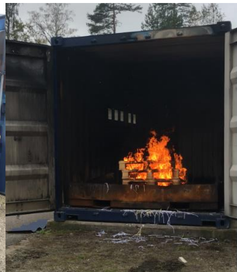
Figur B1.2 Testrigg i form av stålcontainer förberedd inför provning av textilier. De översta fotona visar fem luckor där materialproverna applicerades.
