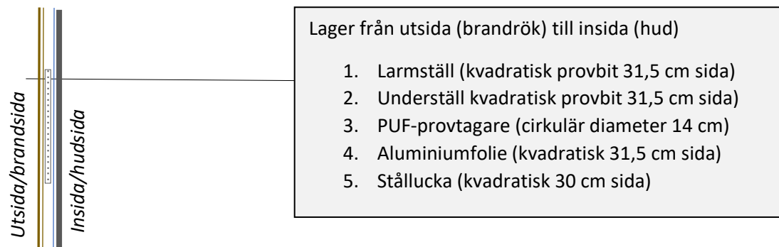
Figur 1. Skiss och foto som illustrerar hur PUF-provtagare och textilier anbringades mot ställuckan i samband med provning av textilprover. Foton som visar arrangemanget återfinns i Bilaga 1.
