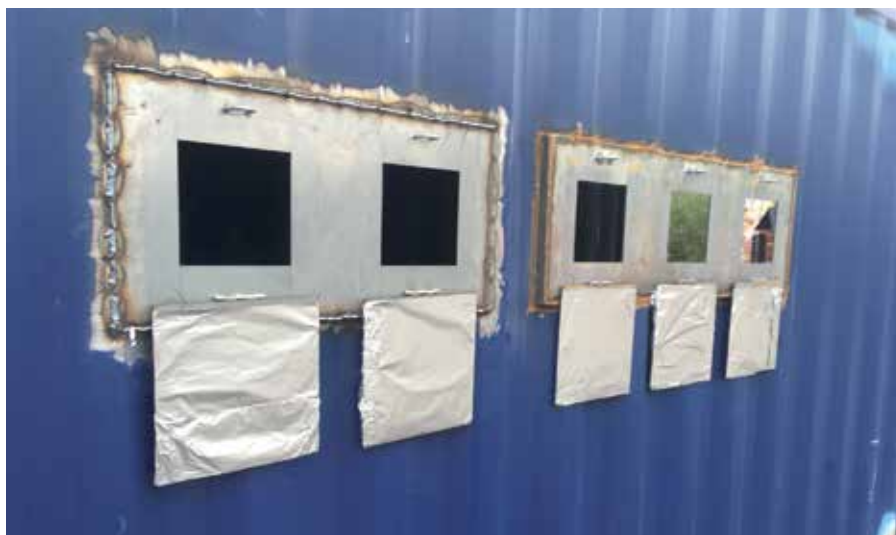
Nedan: Materialtest med provbitar av respektive underställ, monterade i container.
