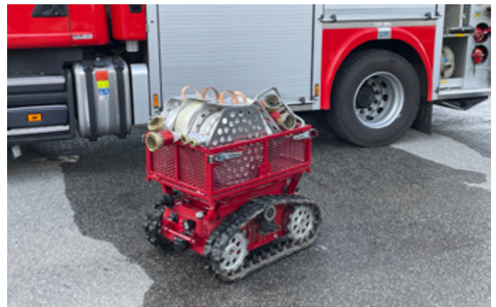
7. Fumo redo för utläggning av brandslang.
