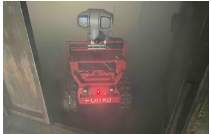
6. Fumo bestyckad med inspektionskamera.
