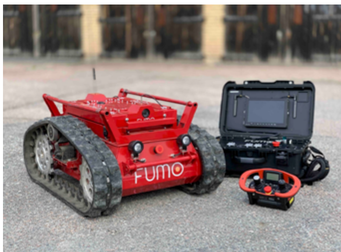
1. I sin enklaste form består Fumo av en grundmodul (till vänster) och en styrkonsoll (nederst till höger). Önskar man bildinformation behövs även basenheten (den svarta väskan överst till höger).
